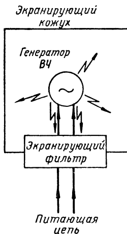
Рис. 2-2. Экранирование генератора высокой частоты.
