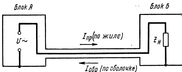
Рис. 2-20. Полное экранирование электрического и магнитного полей.
